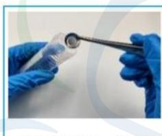
消毒完成后，用无菌镊子将菌片移入装有 5.0 mL 相应中和剂试管中；
