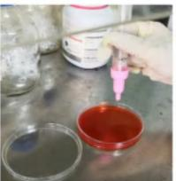
取下瓶盖上的保护盖, 倒置, 将样液按刻度倾注1ml (约20滴) 在培养基平板或纸片培养基上
