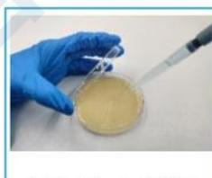
吸取1.0 mL 待检样品接种于无菌平皿（按相应要求培养）；
